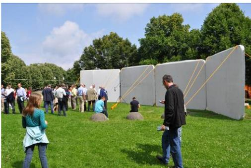
Bild: Aufblasbare Schallschutzwände sorgen bei Rockkonzerten wie Baustellen für einen gedämpften Geräuschpegel.
