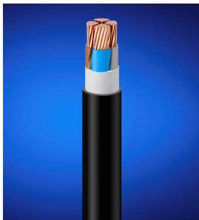
4-adriges, halogenfreies Niederspannungskabel mit verbessertem Verhalten im Brandfall, geeignet für die Erdverlegung
