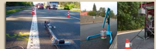
Lasertexturmessung – Strömungswiderstand – Schallabsorptionsgrad
