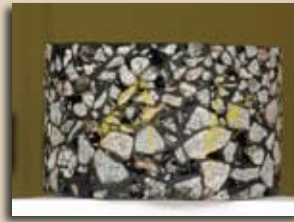
Aufbau eines zweischichtigen offenporigen Asphalts
