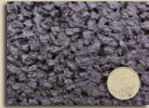
Oberfläche eines lärmarmen Splittmastixasphalts (SMA-LA)
