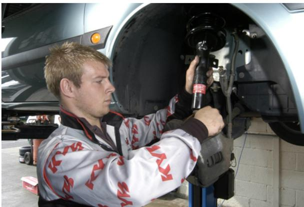
Wer mit defekten Stoßdämpfern fährt, schwebt in großer Gefahr - ohne es zu wissen! So kann sich der Bremsweg um enorme 20 Prozent verlängern. Ein bis zu sechs Meter größerer Bremsweg aufgrund schwacher und müder Stoßdämpfer ist schon bei Tempo 80 km/h möglich. Dies haben Tests des TÜV ergeben. Aber nicht nur hier lauert die Gefahr. Das Auto kann ins Schleudern kommen oder ausbrechen, wenn der Fahrer ein
