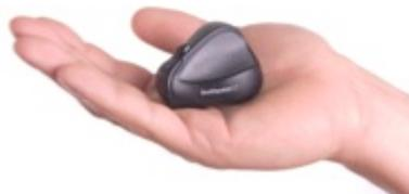
Das Gerät lässt sich über Tasten und ein Scroll-Rad normal bedienen, verhält sich jedoch durch ein Ankippen wie ein virtueller Finger, um Wischbewegungen am Touchscreen zu simulieren. Dadurch wird das schnelle Bewegen von Inhalten ermöglicht und die Bedienung von gestenbasierten Betriebssystemen vereinfacht.
