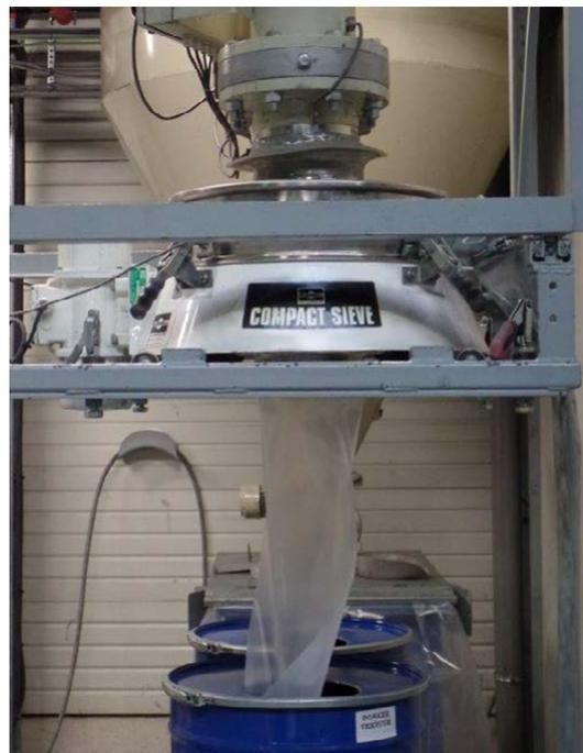
**Abbildung 1** Installation des Russell Compact Sieve® bei Profel Extrusion & Finishing
