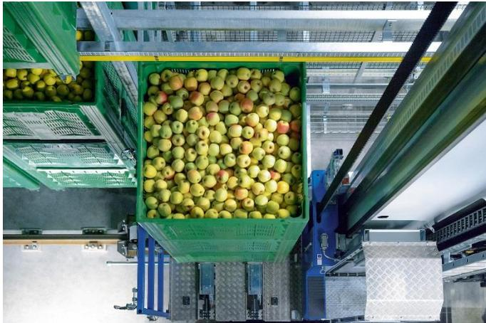
BU: LTW-Regalbediengerät mit Riementechnik im Hub
