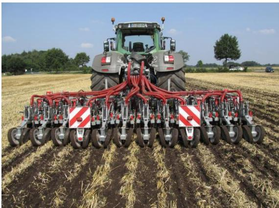
**Bild 1:** Streifenförmige Bodenbearbeitung bei gleichzeitiger Gülleunterfußdüngung mit dem Vogelsang XTill VarioCrop
