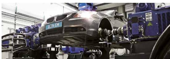
Um belastbar zu sein, müssen Motoren und Getriebe intensiv getestet werden. Mit skalierbaren Umrichtern von PowerTech können ganze Prozesse simuliert werden, was Entwicklungskosten senkt und Entwicklungszeiten verkürzt.
