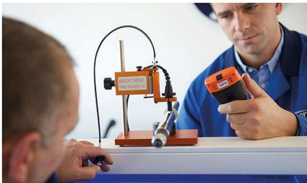
Neben der Charakteristik prüfen die QS-Techniker von OPTIMAL unter anderem die Materialbeschaffenheit, wie beispielsweise die Chromstärken der Kolbenstangen im  $\mu$ -Bereich. Die zusätzliche Kontrolle der zeichnungskonformen Maßgenauigkeit der Stoßdämpfer, wie auch aller anderen Produkte sind dabei Standard und selbstverständlich.
