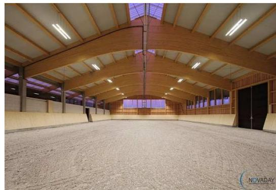
Zudem dürfen die Leuchten Pferd und Reiter nicht blenden und sollten den Boden so einheitlich wie möglich beleuchten. Vor allem sollte der Bereich des »Hufschlags« gleichmäßig ausgeleuchtet werden.
