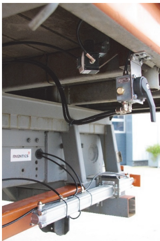
▲ Bild 2: Das Komplettpaket von Aventics besteht aus zwei Pneumatikzylindern, einem handbetätigten Ventil, einem Druckregler sowie Pneumatikschläuchen und den notwendigen Befestigungskomponenten. (Foto: Urheberrecht Aventics)
