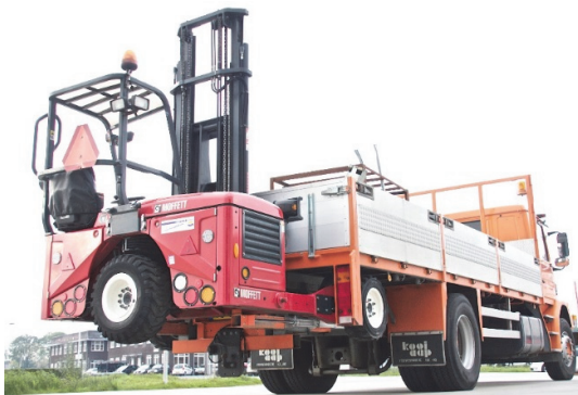
▲ Bild 1: Mit Hilfe von Mitnahmestaplern können schwere Lasten schnell auf- und abgeladen werden. (Foto: Urheberrecht Aventics)
