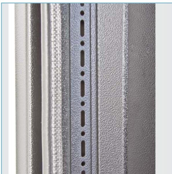
■ Die Basis der RZ Pro Racks stellt der verschweißte und extrem stabile Stahlrahmen dar. Die statische Belastbarkeit beträgt 1,5 T. Dank der umlaufenden Rund- und Langlochung bestehen vielfältige Montagemöglichkeiten am Rahmen selbst. Dichtungen für Türen und Seitenwände können am Rahmen angebracht werden (bei Türen als Standard) und so die Schutzklasse IP54 erreicht werden.
