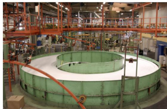
Generell werden Hochspannungskabel für typische Offshore-Projekte in einem Stück mit einer Länge von rund 50 km gefertigt
