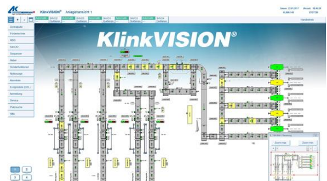
Bild 5: Anlagenübersicht mit Fördertechnik und Regalbediengeräten – schnelle Hilfe durch Fernwartung
