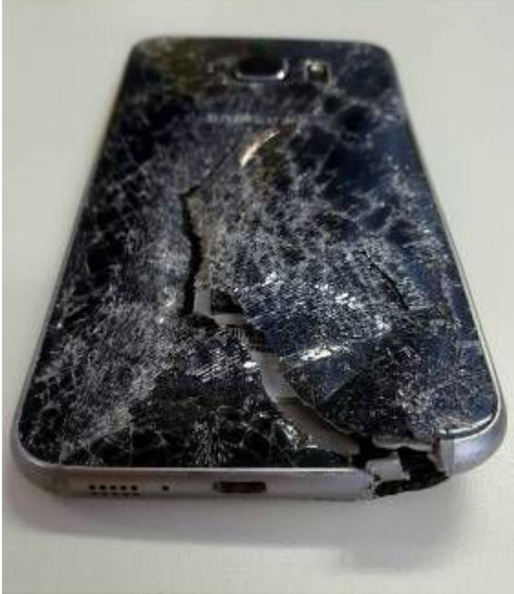
Ein Samsung Galaxy S6 Smartphone, mehrfach an die Wand geworfen. Die Daten des zerstörten Geräts konnten von CBL Datenrettung mit Hilfe des forensischen Chip-Off-Verfahrens wiederhergestellt werden. Bild: CBL Datenrettung
