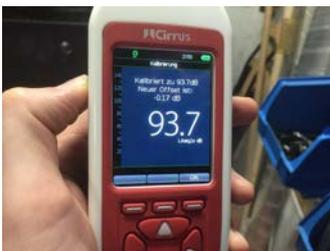
Wenn die Kalibrierung abgeschlossen ist, zeigt das Display an: „um 93.7 dB kalibriert“. Drücken Sie auf „OK“ und entfernen Sie vorsichtig den Schallkalibrator. Drücken Sie die Ein/Aus-Taste auf dem Kalibrator, um ihn auszuschalten. Nun sind Sie bestens vorbereitet: Erfolgreiches Messen!
