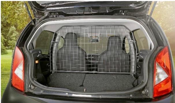
Das Hundegitter wird bei umgeklappten Rücksitzen montiert. © Travall
