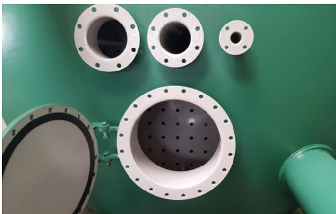
Für den langlebigen Korrosionsschutz von Kies- und Aktivkohlefiltern muss die im Innenbereich aufgebraute Beschichtung herausragende physikalische Eigenschaften aufweisen. Hauptaugenmerk wird hier auf eine äußerst hohe Abriebfestigkeit gelegt, da Kies, Sand und scharfkantige Aktivkohlepartikel durch stetige Reibung immense Abrasion verursachen können.
