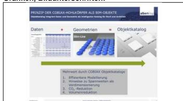
Die intelligenten BIM-Daten von Cobias sind als Objektkataloge in Revit und ArchiCAD einlesbar. Sie stellen dem Planer bereits in der Entwurfsphase wichtige Parameter zur Verfügung.
