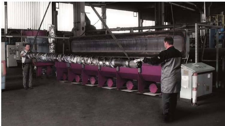
Vakuumpyrolyse-System VACUCLEAN von Schwing Technologies
