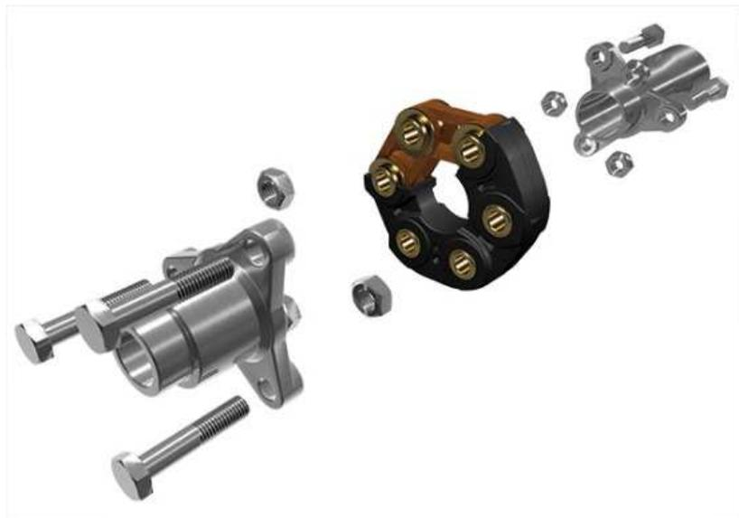
Durch die spezielle Konstruktion der OPTIMAL Gelenkscheiben in Form von innovativ angeordneten Fadenpaketen, einer speziellen Gummimischung und hochwertigen Stahlhülsen können nicht nur Fluchtfehler und axiales Spiel ausgeglichen werden, sondern auch Ruckelbewegungen beim Anlaufen der Welle oder Wechsel der Drehzahl. So lassen sich störende Vibrationen und „Ruckler“ beim Fahren vermeiden.
