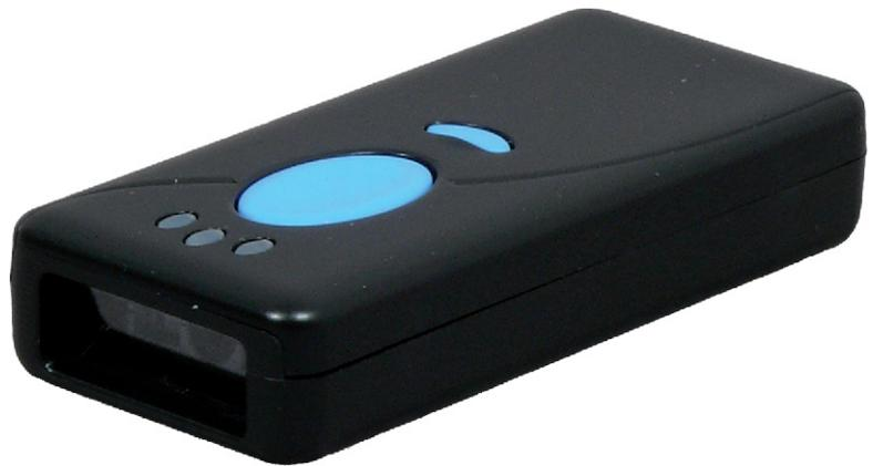
Der BT-4910 von Birch ist ein kompakter, handlicher und universal einsetzbarer CCD-Barcodescanner mit Bluetooth-Technologie, wodurch Sie Ihr Einsatzgebiet um ein Vielfaches zu einem kabelgebundenen Barcodescanner erweitern können. Durch die Verwendung von Bluetooth Klasse 1 Technologien erreichen Sie eine Übertragungreichweite von bis zu 100 Metern.
