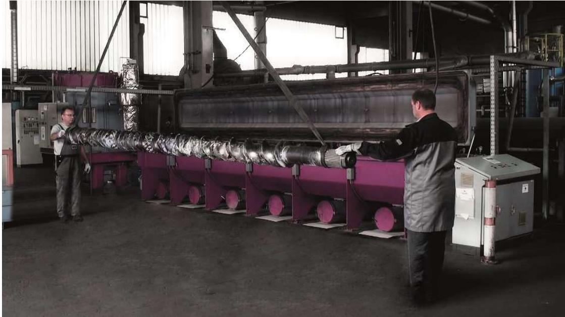
Thermische Vakuumpyrolyse-Anlage VACUCLEAN von SCHWING Technologies
