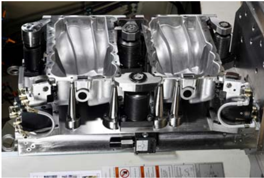
Spannvorrichtung für eine Ölwanne mit positionsflexibler Spannpratze
