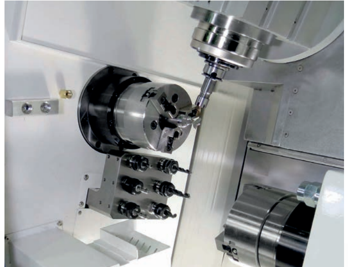
Arbeitsraum mit 6 Innenbearbeitungs-Werkzeugen für Gegenspindel
