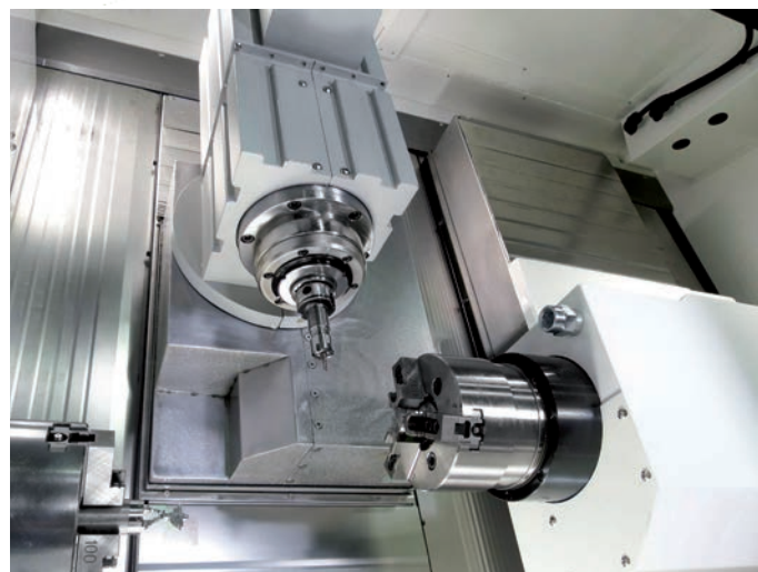
Arbeitsraum turnmill S42
