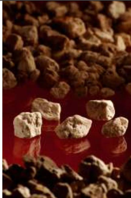
Für Bisootherm-Wandbaustoffe werden ausschließlich ausgewählte Naturbimsstoffe verwendet. Mittels eines eigens entwickelten Verfahrens werden die Naturrohstoffe separiert, in Fraktionen aufgeteilt und dem jeweiligen Produktsortiment zugeordnet.
