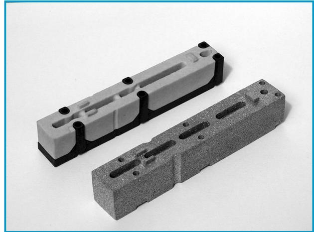
Abmessungen von Platten aus porösem Aluminium können 600x400x150 mm und grösser sein. Dabei ist zu berücksichtigen, dass das spezifische Gewicht von porösem Aluminium beträgt nur 1,2 – 1,35 g/cm<sup>3</sup>.
