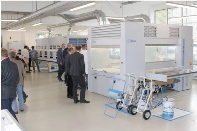
(BU): Vorstellung neuester Technologien zum Einstieg in eine umweltschonende Applikation von Holzoberflächen mit schadstoffreduzierenden, wässrigen Lacken. Für Probeläufe steht die HOMAG Spritzlackiermaschine SPRAYTEQ S-100 bereit.
