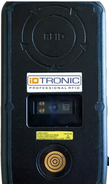
Das Gerät verfügt über einen **RFID UHF Long Reader** mit einer Lesereichweite von bis zu 4 Metern. Es funktioniert ausnahmslos in großen Lagerumgebungen und erfasst die Daten zuverlässig.
