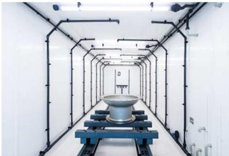
*Blick in die Rotainer-Beizanlage von Siedentop: Im geschlossenen Container-System werden die Bauteile mit Tauchbeize besprüht.*
