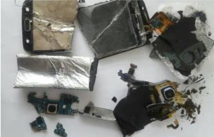
Wenn nur noch zusammengekehrter Elektroschrott von einem Handy übriggeblieben ist, beginnt „Datenrettung extrem“: CBL wendet mit großem Erfolg das Chip-Off-Verfahren aus der Computerforensik an. Bild: CBL Datenrettung
