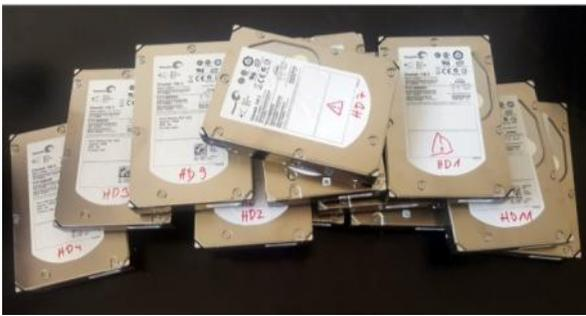
Nur die Festplatten, am besten durchnummeriert, benötigt CBL Datenrettung, um mit proprietären, völlig hardware- und betriebssystemunabhängigen Methoden die Daten zerstörter RAID-Systeme wiederherzustellen. Der Kunde kann bereits während der Datenrettung seinen RAID-Server mit neuen Datenträgern wieder aufbauen. Bild: CBL Datenrettung
