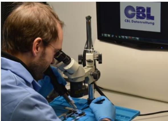
[Aufwändig aber vielversprechend: Bei zerstörten Smartphones mit Hardwareverschlüsselung müssen Datenretter mikroskopisch kleine Baugruppen auf der Platine des Geräts bearbeiten, um die Entschlüsselung der Daten zu ermöglichen. Bild: CBL Datenrettung](#)
