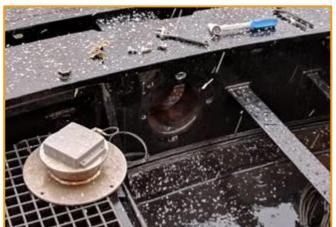
Auf der Innenseite des Karussells sind 60 UHF Tags alle 6 Grad angebracht; mit der BLUEBOX CX LR 1CH und der zugehörigen MR Antenne werden die Tags gelesen. Die BLUEBOX CX LR 1CH ist in der Technikkabine auf dem Schiff angebracht. Die MR Antenne ist außen an einer speziellen Antennenvorrichtung montiert.
