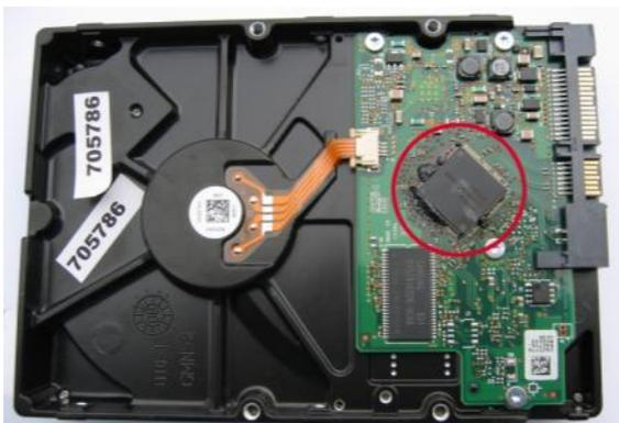
Festplatten können beispielsweise durch Überspannung etwa in Folge eines Blitzeinschlags zerstört werden – im Reinraumlabor von CBL Datenrettung wird der Datenträger soweit wiederhergestellt, dass die Daten ausgelesen werden können.
