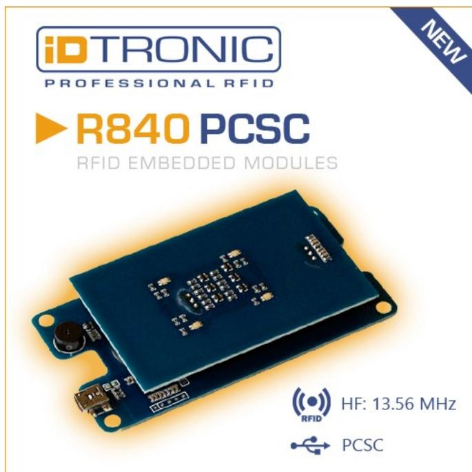
iDTRONIC als führender Anbieter für einbettbare RFID Module hat die **Embedded HF RFID Reader Serie R840** um eine **PC/SC Schnittstelle** erweitert. Das RFID OEM Modul gibt es bereits mit den Schnittstellen **USB VCP**, **USB HID** und **Ethernet**. Die neue **PC/SC Schnittstelle** dient dem Einlesen von **Smart Cards** mittels eines **Chipkartenlesegeräts**. Diese Funktion soll die **Authentifizierung** von **befugten Personen** in bestimmten Bereichen erleichtern.
