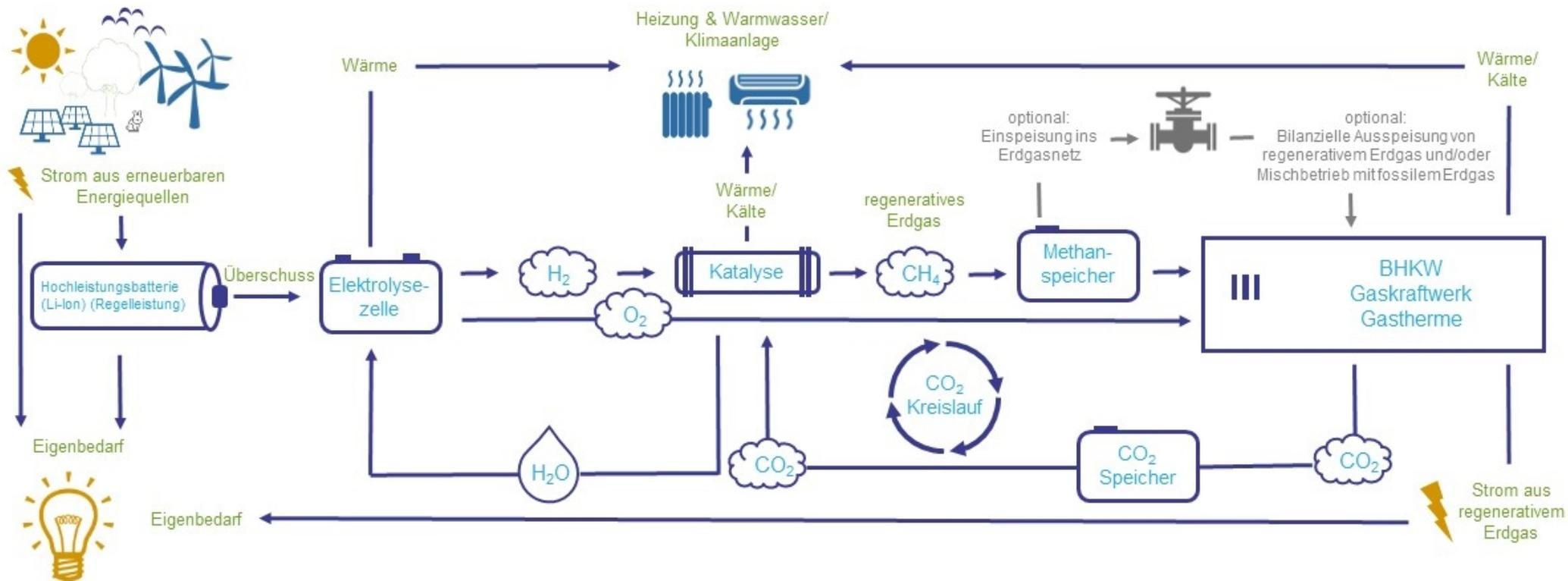
Funktionsprinzip der SmartEnergyTechnology mit einem Gesamtwirkungsgrad (Nutzungsgrad) bis über 90 % durch Sektorkopplung
