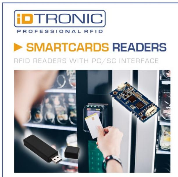
Die **PC/SC** Schnittstelle ist eine flexible Anbindung zwischen einem Chipkartenleser und dem Computer. **PC/SC** leitet sich von den Begriffen „**Personal Computer**“ und „**Smart Card**“ ab. Die Schnittstelle ermöglicht das Einlesen von Smartcards im PC-Umfeld. Der PC/SC Standard ist plattform- und herstellerunabhängig und ist somit in jedes Betriebssystem integrierbar. Mögliche Chipkarten sind Kundenkarten, Mitarbeiterausweise, Krankenkassenkarten, NFC-basierte EC- oder Kreditkarten.
