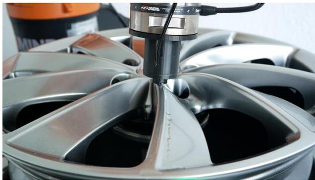
Bild 3: Der konstante Anpressdruck des Prüfkopfes lässt sich mit einem Kraft-Momenten-Sensor sicherstellen;
