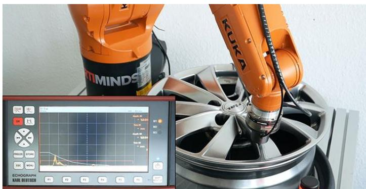
Bild 1: Kraft geregelt fährt der Roboter die komplexe Geometrie der Felge mit dem Ultraschallprüfkopf ab, um nicht sichtbare Fehlstellen zu detektieren;
