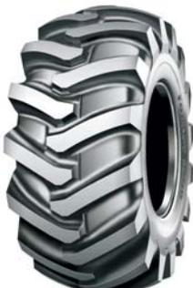
Die Konstruktion der robusten Spezialreifen Nokian Forest King TRS LS-2 ist verstärkt worden. Eine höhere Tragfähigkeit samt einer Tubeless-Konstruktion sorgen bei Bodenbearbeitungsmaschinen und großen Skidern für mehr Zuverlässigkeit und Leistungsfähigkeit im anspruchsvollen Sondereinsatz. Die neue Tragfähigkeitsklasse der Größen 28L-26 und 30.5L-32 beträgt 26 PR, früher 16/18 PR.
