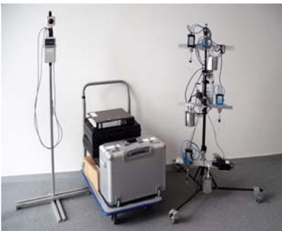
**Bild:** Der mobile Messbaum kann in einem Koffer verstaut und somit problemlos transportiert werden, um vor Ort für Spotmessungen (kurze Momentaufnahmen der Raumklima-Parameter) eingesetzt zu werden.
