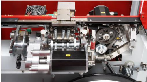
(Kompaktes Umreifungsaggregat mit DC-Motoren)
