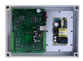
SMART Technologies bietet mit dem Control Net II und Control Net IV preisgünstige Türcontroller für den universellen Einsatz. Durch die integrierte Ethernet TCP/IP – Schnittstelle, sind Control Net II und Control Net IV optimal geeignet für die vernetzte Zutrittskontrolle ohne aufwendige und kostenintensive Verkabelung wie bei herkömmlichen Systemen.
