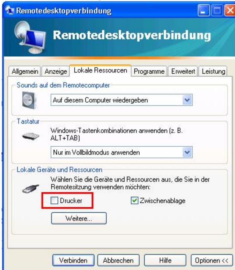
Nach der Anmeldung auf dem Terminalserver wird der Sessionserver gestartet und die gewählten Drucker erstellt. Auf dem Server werden die Clientdrucker mit der Namensgebung Clientname Druckername erstellt. Dies hat den Vorteil, dass die lästige Verwendung der SessionID in der Namensgebung bei Verwendung des rdp-Protokolls entfällt. Nachteilig ist die Möglichkeit gleicher Rechnernamen bei WAN-Anbindung. Das lässt sich aber administrativ bereinigen.
