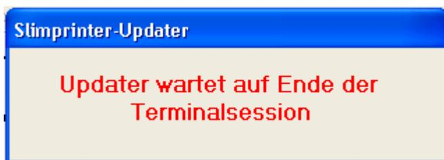
Wenn auf dem Client alle Instanzen von Mstsc.exe beendet sind, wird das Clientupdate ausgeführt und das obige Fenster geschlossen.
