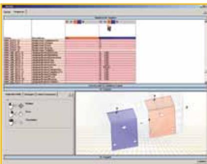
Das gefundene, geometrisch ähnliche Teil kann in einer 3D-Ansicht mit dem konstruierten Teil verglichen und vermessen werden.
