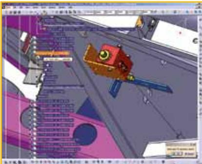
Im jeweiligen CAD-System wird ein Bauteil entworfen, dessen 3D-Geometrie zur Suche herangezogen wird.
