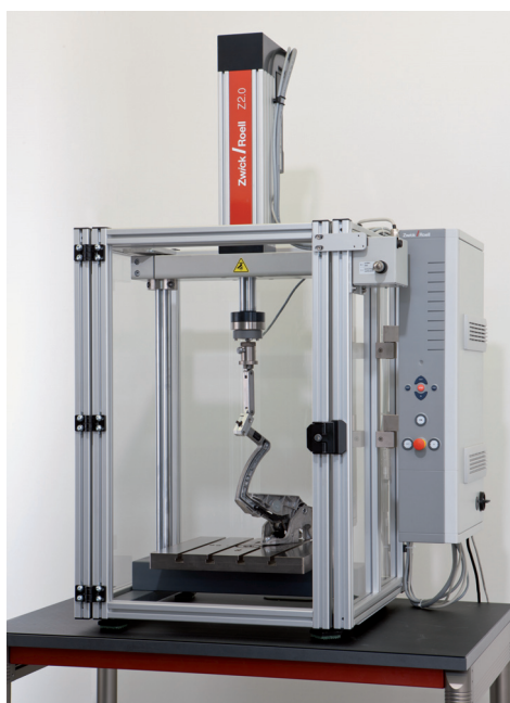
Bild: Servoprüfzylinder für Ermüdungsprüfungen an Handbremsen
