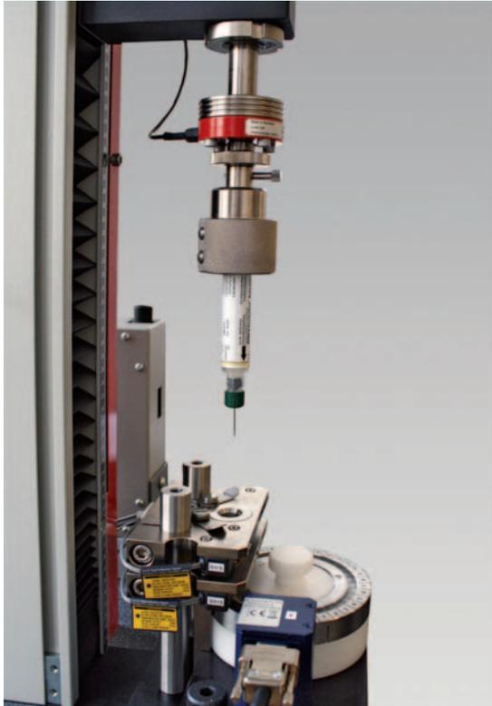
*Bild: Prüfmaschine zwicki-Line für die Bestimmung der Ejektionscharakteristik von Autoinjektoren*
