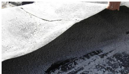
HDPE-Sperrschicht-Kammer gefüllt mit Poraver.
