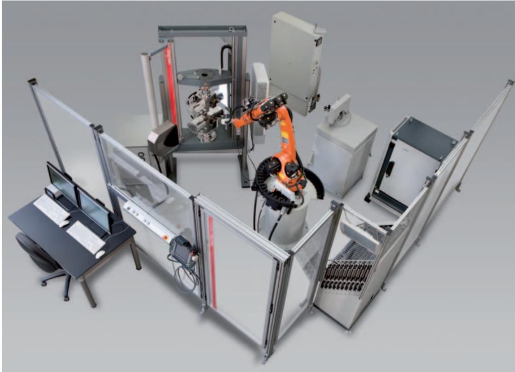
*Bild: Roboter-Prüfsystem von Zwick für Zugversuche an Metallen gemäß ISO 6892-1 (2009)*
