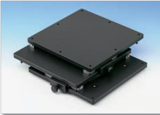
Kreuzschiebetisch 100 x 100 mm mit geschlossener Platte für Auflichtanwendungen. Das Verschieben erfolgt per Hand (ohne Feinverstellung). Bei Bedarf können die Komponenten CV-MT-25, CV-KT-85 und CV-RT-85 auf dem Kreuzschiebetisch montiert werden. Mit den Rändelschrauben kann die Position fixiert werden.
