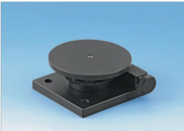
Im Zentrum der Auflageplatte befindet sich eine Bohrbuchse mit drei mm Durchmesser zur Aufnahme von weiteren Haltevorrichtungen. Die Auflageplatte hat einen Durchmesser von 85 mm. Der CV-RT-85 kann mit dem Kreuzmesstisch CV-MT-25 und CV-MTU-50 (wird mit einer zusätzlichen Adapterplatte verschraubt) kombiniert werden. Zur Aufnahme von runden Teilen ist ein Prisma aus weißem POM mit Passstift optional lieferbar. Der CV-RT-85 kann optional auf die
