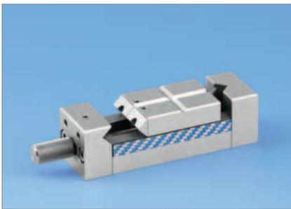
Universeller Präzisionsschraubstock zum feinfühligem Klemmen und Spannen von rotationssymmetrischen und prismatischen Präzisionsteilen mit empfindlichen Oberflächen bzw. Werkstoffen. Das Gerät besteht aus gehärtetem, korrosionsbeständigem Stahl (NIRO) und beinhaltet umfangreiches Zubehör. Alle Flächen sind hochpräzise geschliffen ( $< 2\mu\text{m}$ ). Werkstücke können präzise und wiederholbar (hochgenaue Spannflächen
