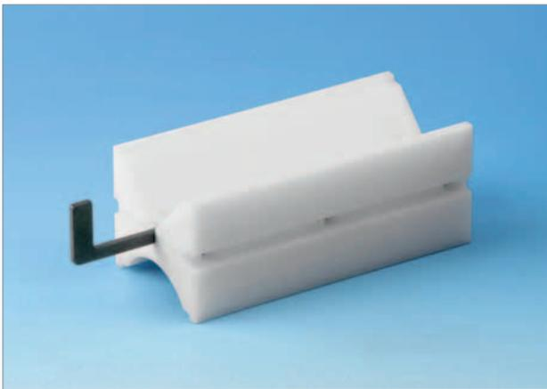
Prismen in der Länge von 50, 100 oder 150 mm, eine Seite als Prisma und die andere Seite als Halbschale ausgearbeitet. Die Einlegeprismen werden inklusive einem rückwärtigen Anschlag geliefert der mittels beidseitig vorhandenen Imbusschrauben fixiert werden kann. Die Prismen sind aus weißem POM gefertigt, damit keine Beschädigungen am Prüfling entstehen können. Außerdem ist eine optimale Ausleuchtung durch das weiße
