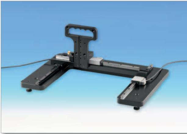
Ein alternatives Konzept zum klassischen Kreuzmesstisch ist der CV-ST-VHX-300-MT. Mit einem Verfahrbereich und Messbereich von 300 x 300 mm innerhalb des Rahmens ist der Platzbedarf gegenüber einem normalen Kreuzmesstisch mit dem dazu gehörigen Stativ extrem verringert. Die Präzisionsführungen ermöglichen ein leichtes Verschieben der Optik in X und Y. An beiden Achsen ist jeweils eine Feinverstellung mit Fixierschraube integriert. Die Messsysteme sind in
