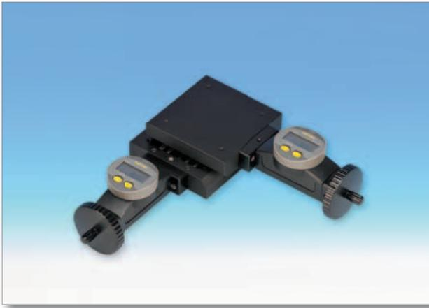
Kreuzmesstisch 25 x 25 mm mit digitalen Messspindeln 0.001 mm. Beide Seiten haben jeweils vier Innengewinde M4 zur Befestigung. Der CV-MT-25 kann mit dem Rotationstisch CV-RT-85 und dem Kugeltisch CV-KT-85 kombiniert werden. Bei Einsatz von digitalen Messspindeln können über optionale Datenkabel die XY Koordinaten in der Messsoftware Metric MT ausgelesen werden. Dies ermöglicht unter anderem den Einsatz der DXF Overlay Funktion. Alternativ ist der Kreuzmesstisch silbern eloxiert lieferbar.
