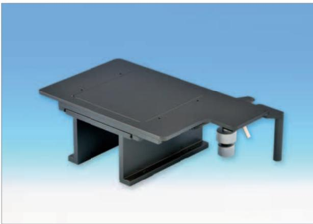
Präzisionskreuzschiebetisch 100 x 100 mm ausgerüstet mit hochgenauen Kreuzrollenführungen. Das Verschieben erfolgt über die seitlich angebrachte Rändelschraube in X und Y. Die Montage erfolgt mittels der L-Leisten. Der CV-EK-100 wird je nach Anforderung mit einer Metall- oder Glaseinlegeplatte geliefert (bei Bestellung bitte angeben).
