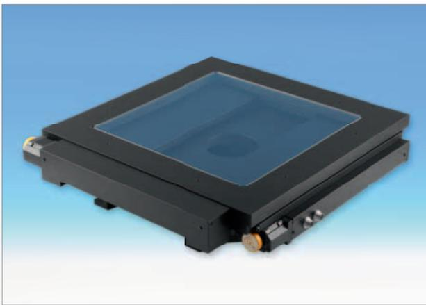
Mit 2-Phasen Schrittmotoren ausgerüsteter Kreuzmesstisch mit einem Messbereich von 300 x 300 mm. Der Messtisch ist mit einer Spindelsteigung von 1, 2 oder 4 mm erhältlich. Die Wiederholgenauigkeit beträgt 1 Mikron. Der Tisch wird wahlweise mit einer Metalleinlegeplatte oder einer Glaseinlegeplatte für Unterlichtanwendungen geliefert. Die Messsysteme können in Kombination mit einer PCI- oder Tischsteuerung von der Metric MT ausgelesen werden (siehe Steuerung Tango).
