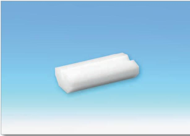
Für das Einlegen von kleinen Bohrern oder anderen rotationssymmetrischen Teilen wird das Einlegeprisma CV-EP-PPOM-4 oder CV-EP-PPOM-10 eingesetzt. Der Unterschied zwischen den beiden Typen ist die Tiefe der Keilnut mit 4 oder 10 mm. Diese Einlegeprismen aus weißem POM können alternativ mit einem Passstift in den Rotationstisch CV-ROT-85 eingesteckt werden.
