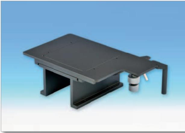
Präzisionskreuzschiebetisch 150 x 150 mm ausgerüstet mit hochgenauen Kreuzrollenführungen. Das Verschieben erfolgt über die seitlich angebrachte Rändelschraube oder bei Umlegen des Hebels durch Bedienung des Handgriffes (Schnellverstellung) in X und Y. Die Montage erfolgt mittels der L-Leisten. Der CV-EK-150 wird je nach Anforderung mit einer Metall- oder Glaseinlegeplatte geliefert (bei Bestellung bitte angeben). Die CV-
