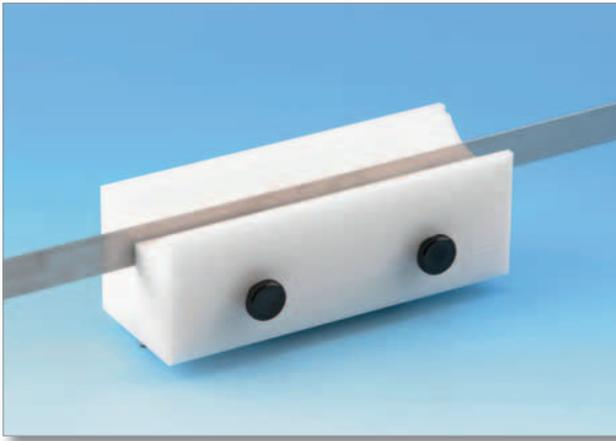
Klemmvorrichtung aus POM für dünne Stahlbänder, die als Halbschale ausgearbeitet ist. Auf den innen gefrästen Auflagerand kann eine externe koaxiale Beleuchtung eingelegt werden, um perfekte, reflexionsarme Bilder zu erzeugen. Die Klemmvorrichtung CV-KM-200 ist mit Passtiften ausgestattet, um diese auf die Kreuzschiebetische CV-KT-100 und CV-KTU-100 zu stecken. Optional ist Adapterplatte für den Kreuzmesstisch CV-KTU-50
